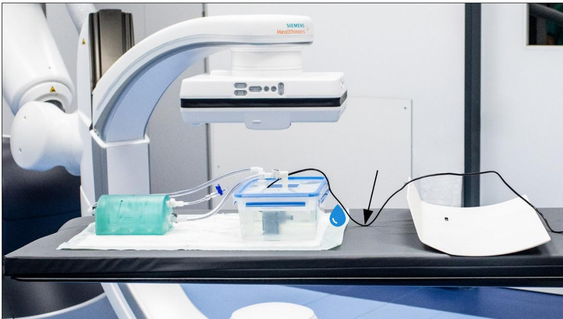
4. Stellen Sie den Phantomkörper auf die C-Arm-nahe Seite der saugfähigen Unterlage neben das Reservoir.
